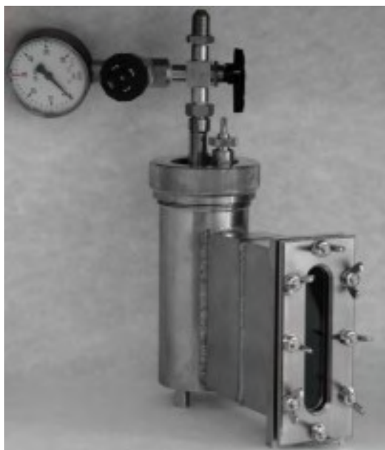
Rys. 1. Reaktor wysokociśnieniowy (zmodyfikowana bomba kalorymetryczna) do syntezy nanowłókien węgla krzemu SiC
