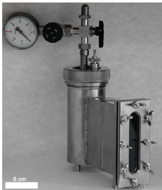
Rys. 1 Zmodyfikowana bomba kalorymetryczna
